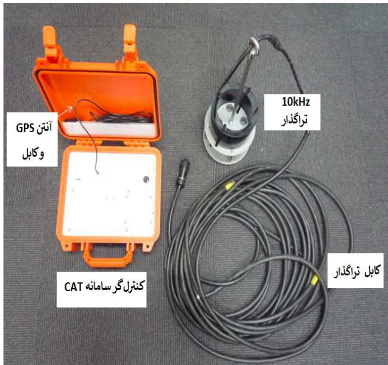
اجزا دستگاه پرتونگاری مقطعی صوتی
